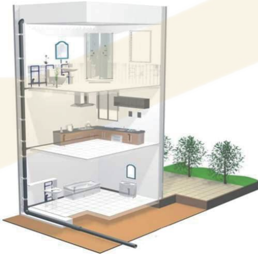
同层排水系统示意图
