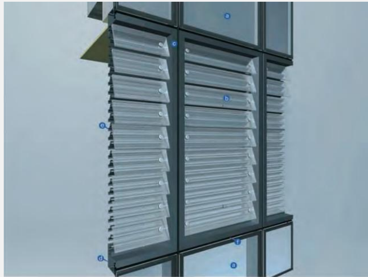
单元幕墙玻璃百叶局部立面图
