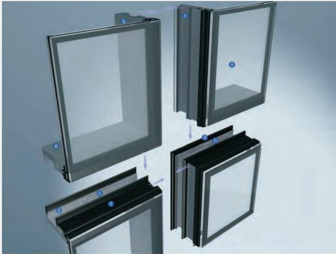
幕墙单元板块吊装示意图
