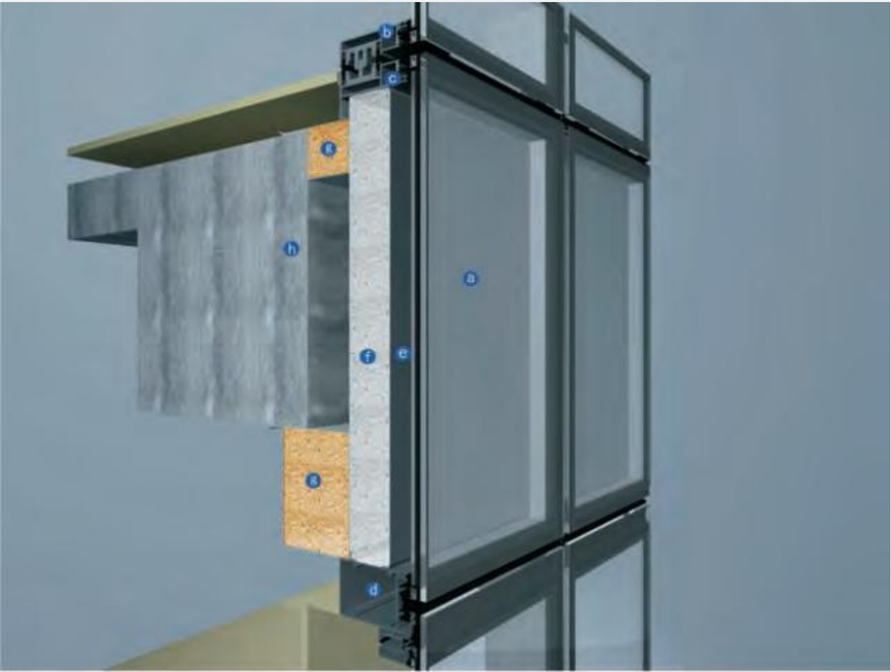
单元幕墙结构梁层间剖面防火图
